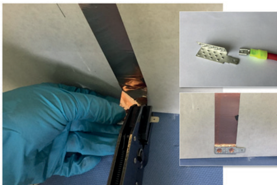
Abbildung 8: links: Crimpen der Kontakte, rechts oben: Crimp-Kontakt und Kabel, rechts unten: angeklebte Elektrode inklusive Crimp
