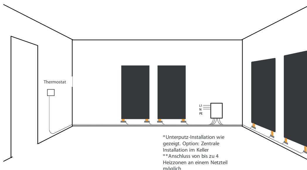
Abbildung 2: Installationsbeispiel von vier Heizflächen in einem Raum
