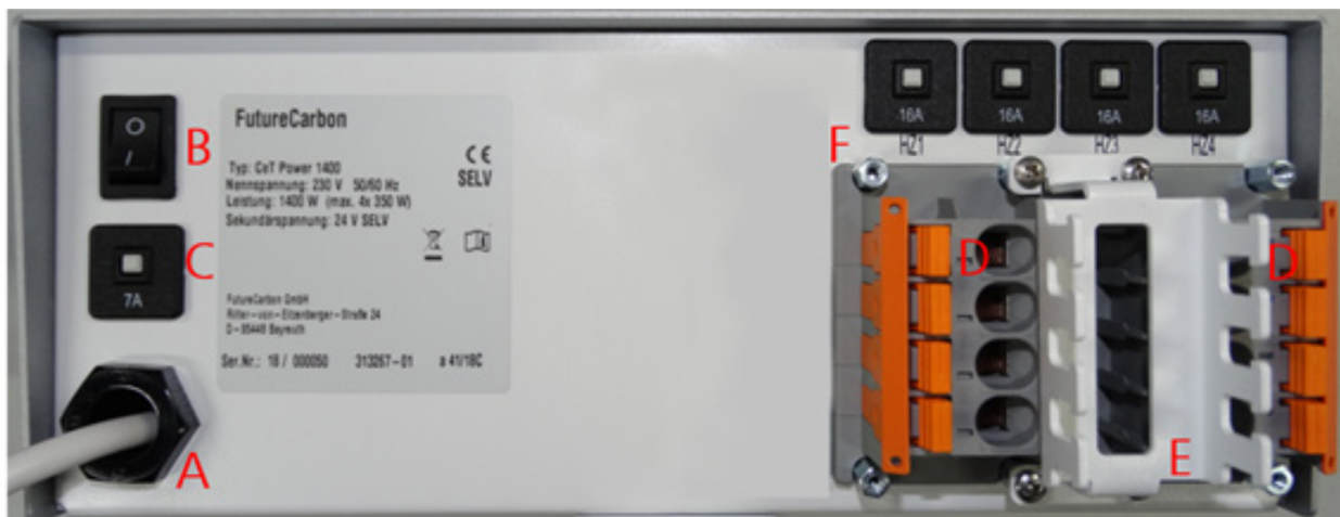
Abbildung 1: Übersicht der Spannungsversorgung CeT Power 1400 AP
