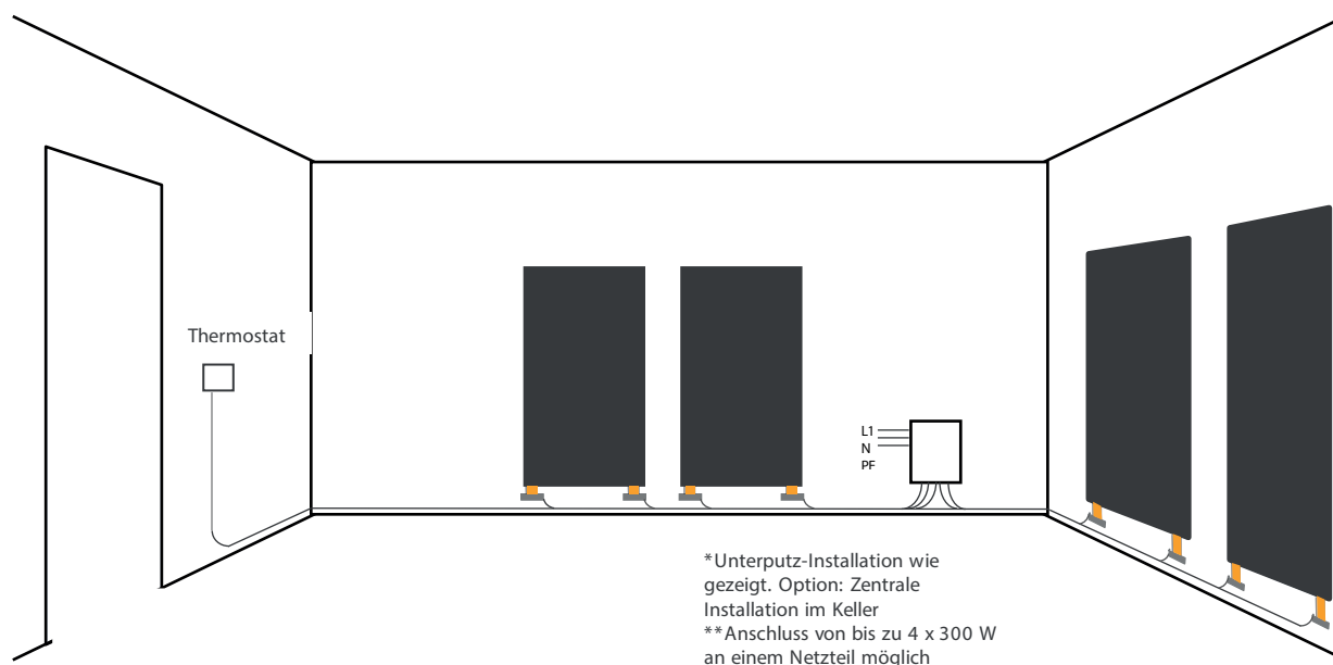
Abbildung 2: Installationsbeispiel von Heizflächen an den Wänden
