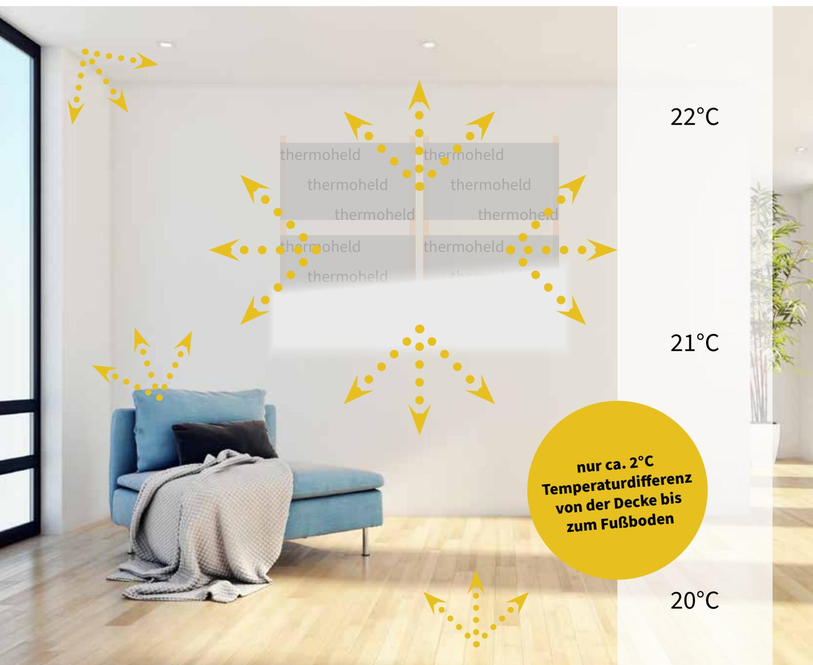
thermoheld Wärme wirkt nicht auf die Luft sondern direkt auf Körper, Gegenstände & Wände im Raum. Diese reflektieren die Strahlung. Der Raum wird warm.
