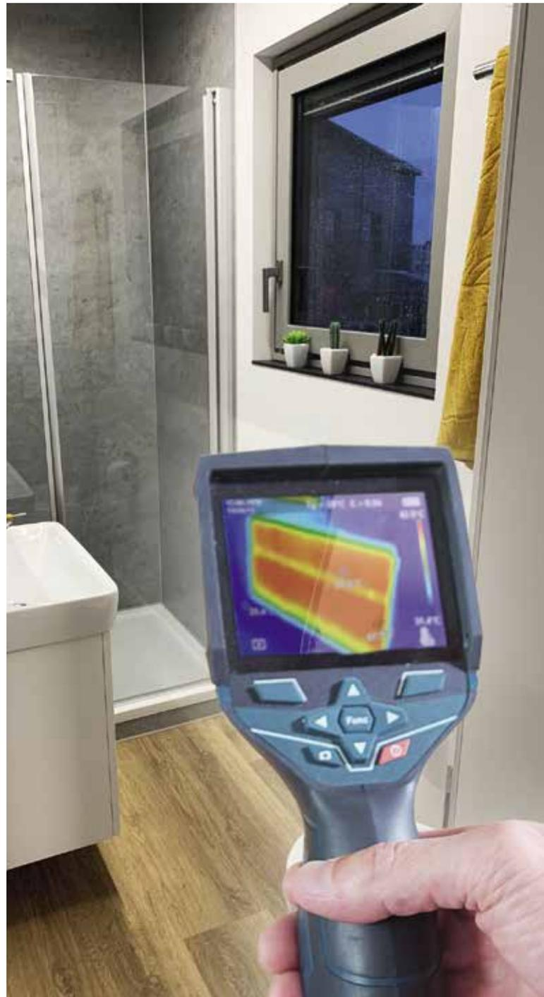
Unsichtbare thermoheld-Infrarotheizung mit Wärmebildkamera
