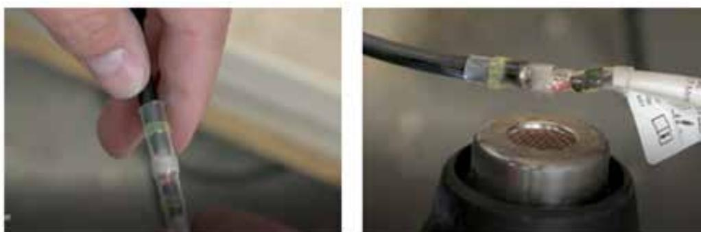
**Abbildung 24: Verlängern der Zuleitungen mithilfe der beigelegten Lötverbinder**
