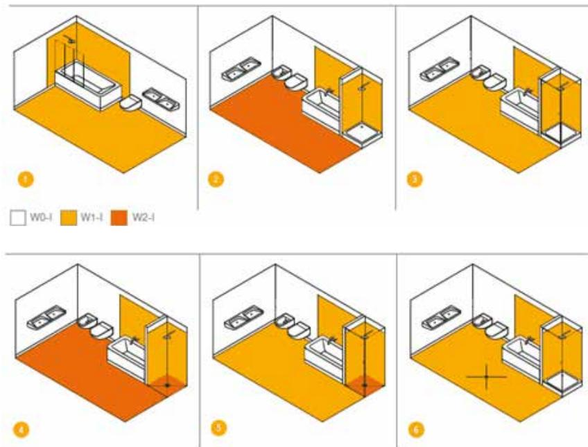
**Abbildung 1: Beispiele für die Wassereinwirkungsklassen nach DIN 18534 in verschiedenen Badsituationen. Die zu berücksichtigenden Flächen, die abgedichtet werden müssen, wurden gelb, Einwirkungsklasse W1-I, und orange, Einwirkungsklasse W2-I, markiert.**
