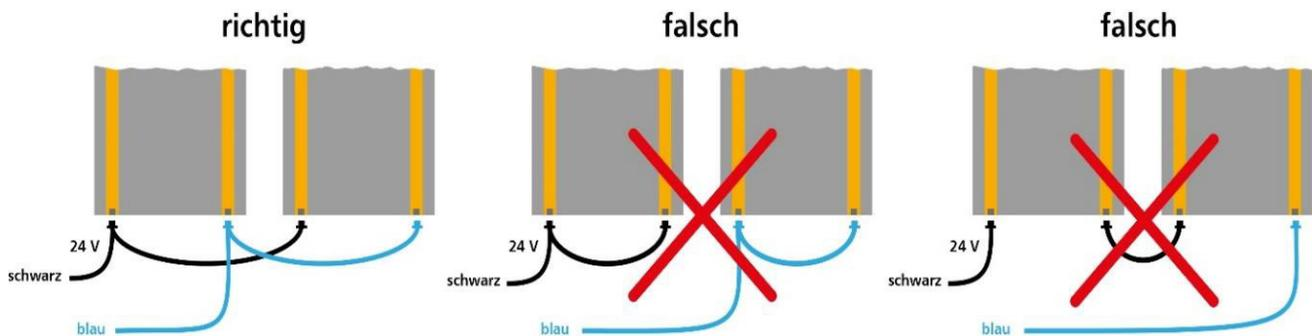
**Abbildung 9: Bei einer geteilten thermoheld •WAND• können die einzelnen Platten (bis maximal 8 Heizfelder bzw. 300 W) durch Wago Klemmen in Unterputzdosen wieder zusammengeschlossen werden. Hier ist die korrekte und die fehlerhafte Verbindung der Heizstränge dargestellt.**
