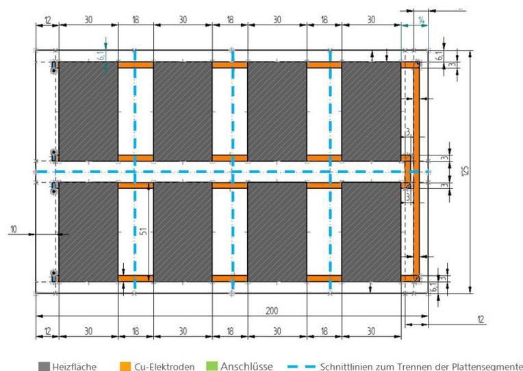
**Abbildung 1: Technische Zeichnung thermoheld •WAND•, Vorderseite, Bemaßung in cm**
