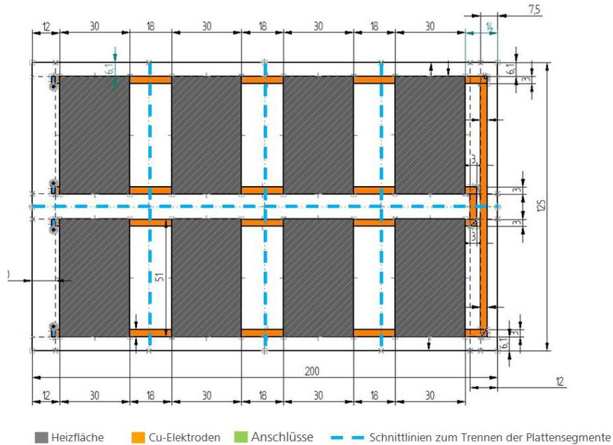
**Abbildung 11: Technische Zeichnung thermoheld •WAND•, Vorderseite, Bemaßung in cm**
