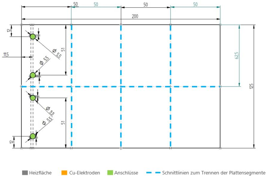
**Abbildung 12: Technische Zeichnung thermoheld •WAND•, Rückseite, Bemaßung in cm**
