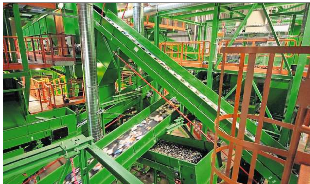
Das ist der Weg der Verpackungen: Sie werden über den gelben Sack oder die gelbe Tonne eingesammelt, dann getrennt und sortiert und schließlich zur Wiederverwertung abtransportiert. Fotos: BellandVision
