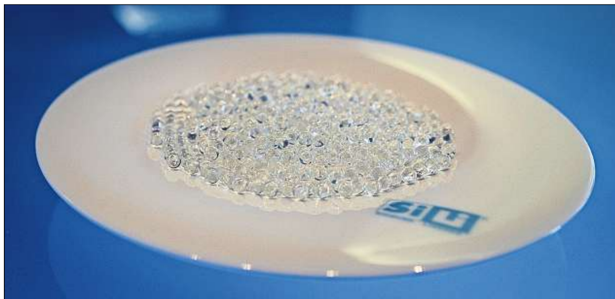
So sehen die Glaskugeln aus, die SiLi für die Produktion von Impfstoffen herstellen wird.
